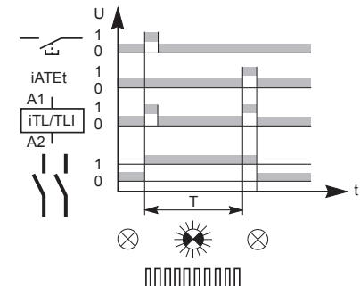
**Commande en Très Basse Tension (TBT)/Extra low voltage (ELV) control/Steuerung bei Kleinspannung/Sturing op zeer laag spanning (ZLS)/Comando a bassissima tensione (TBT)/Mando en Muy baja Tensión (TBT)/Управление нагрузкой в цепи сверхнизкого напряжения/超低压 (ELV) 控制**
