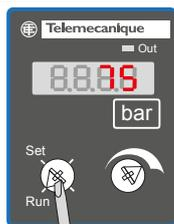
Ripartire poi indietro il selettore sulla posizione «Run». La funzione «NC» è attivata e viene visualizzata la pressione del fluido.
