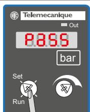
Girare il selettore a rotazione sulla posizione «Set». Viene visualizzato «PaSS», con la richiesta di specificare una password.
