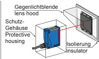
Außenmontage bitte nur mit Schutzgehäuse. Auf eine Isolierung gegen Frost ist zu achten um Kondenswasser auf optischen Teilen zu vermeiden.
