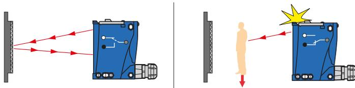
Ausgangssignal bei Erfassung / Signals a presence
