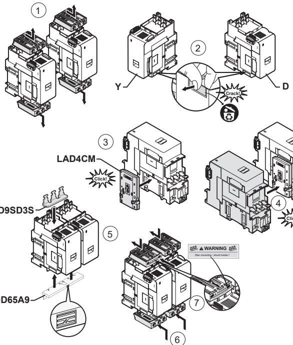
Disassembly / Désassemblage / Desmontaje / Demontage / Smontaggio / Desmontagem / Sökme / 拆卸 / Разборка
