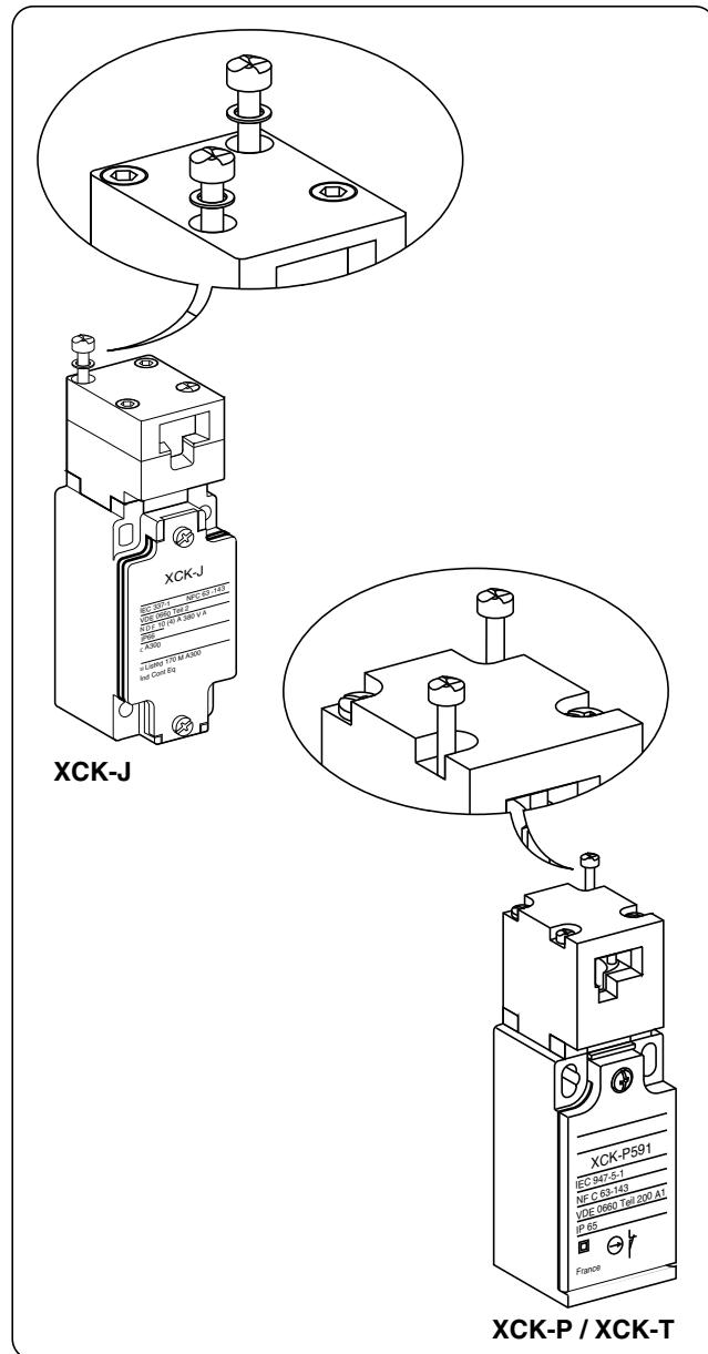
**Français****Vis indémontables en option pour les interrupteurs de position de sécurité XCK-J / XCK-P / XCK-T**
