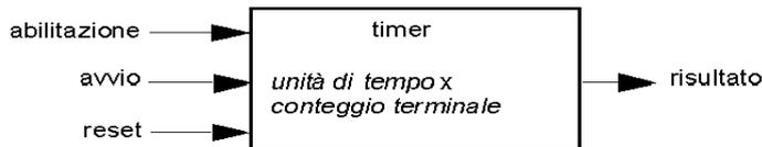
L'ingresso di attivazione attiva il timer nella posizione 0 e accumula *unità di tempo* (unità di 1, 10, 100 o 1000 ms) per un numero specificato di conteggi. L'ingresso di reset azzerava l'accumulatore del timer.
