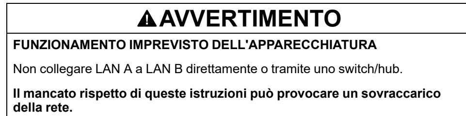
**NOTA:** non collegare LAN A a LAN B direttamente o tramite uno switch/hub, in quanto ciò potrebbe provocare un sovraccarico della rete e determinare una reazione di errore da parte del sistema M580.
