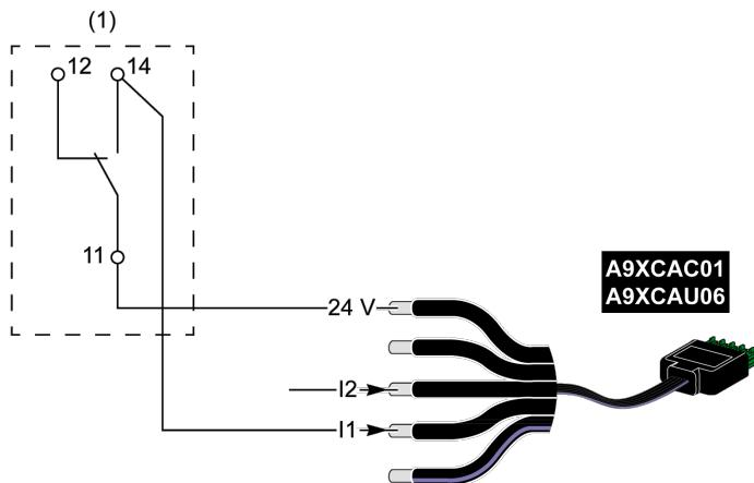
**(1)** Contatto trasferimento remoto dello scaricatore di sovratensione: stato cartucce
