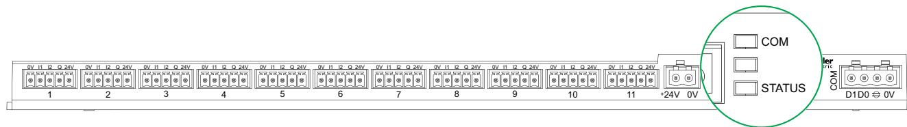
Il LED **COM** indica lo stato comunicazione Modbus seriale di I/O Smart Link:
