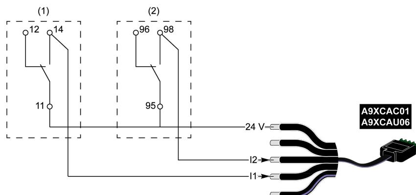
**(1)** Contatto di trasferimento remoto dello scaricatore di sovratensione PRD1 25r e PRD1 35r o PRD1 Master: stato cartucce
