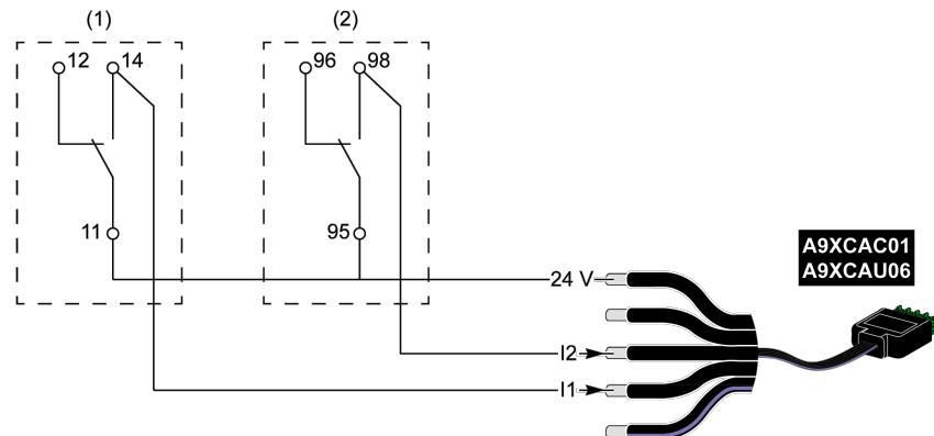
**(1)** Contatto trasferimento remoto dello scaricatore di sovratensione iPRF1 12.5r: stato scaricatore di sovratensione
