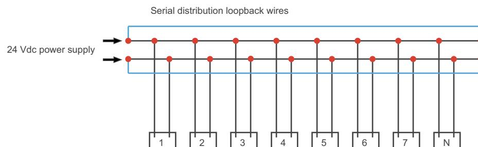
In una rete di distribuzione elettrica di scarsa qualità, si consiglia di utilizzare un alimentatore conforme a OVC II, in grado di tollerare fino a 500 Vca in ingresso e offrire anche l'isolamento galvanico tra l'ingresso CA dell'alimentatore e l'uscita CC dell'alimentatore da 4 kVca a 50 Hz.
