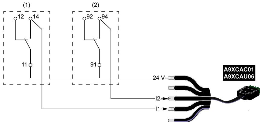
**(1)** Contatto di trasferimento remoto dello scaricatore di sovratensione iPRD: stato cartucce
