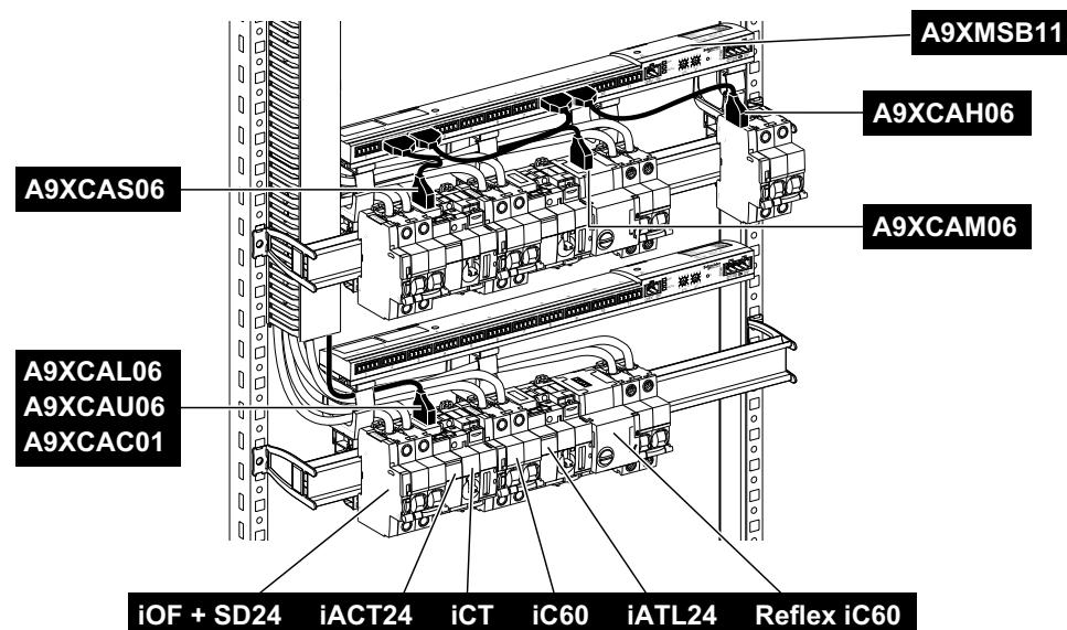
**NOTA:** è possibile utilizzare il cavo A9XCAU06 o A9XCAC01 per collegare dispositivi Acti 9 con interfaccia Ti24 a I/O Smart Link.
