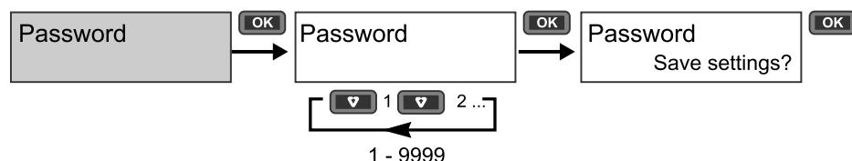
1. Accedere alla modalità di configurazione e premere il pulsante **▼** fino a **Password** quindi premere **OK** per accedere alla configurazione della password.
