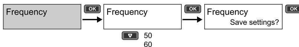
1. Accedere alla modalità di configurazione e premere il pulsante fino a **Frequency** quindi premere per accedere alla configurazione della frequenza.
