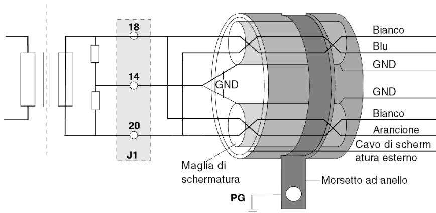
**NOTA: importante:** La schermatura principale del cavo viene messa a terra usando un anello metallico che viene messo a contatto con la maglia, che a sua volta è fissato alla struttura di supporto del rack.
