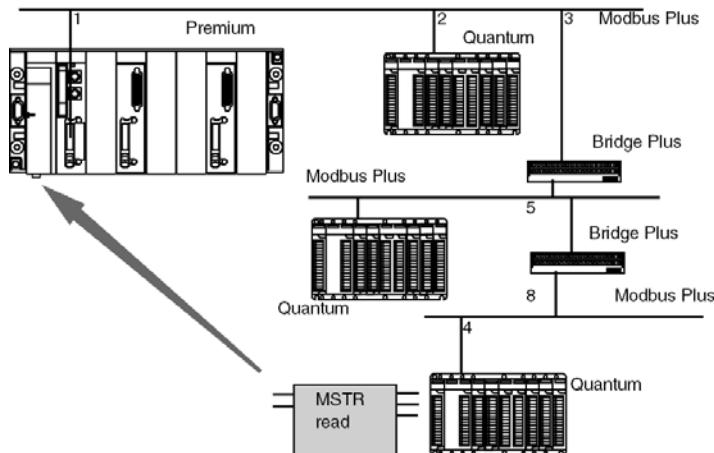
La stazione Quantum trasmette una richiesta di lettura alla stazione Premium utilizzando un percorso di indirizzo: 8.5.1.0.0 (routing path).
