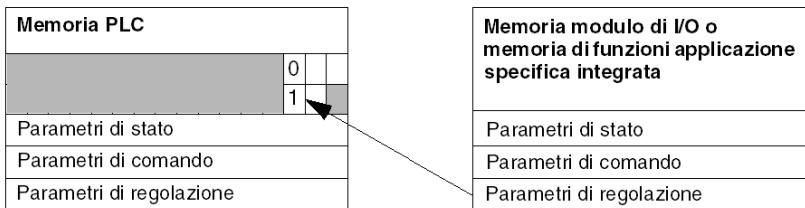
Quando vengono scambiati dati tra la memoria del PLC e il modulo, il riconoscimento da parte del modulo è gestito dal bit **ADJ\_ERR** (%MW<sub>r.m.c.1.2</sub>).
