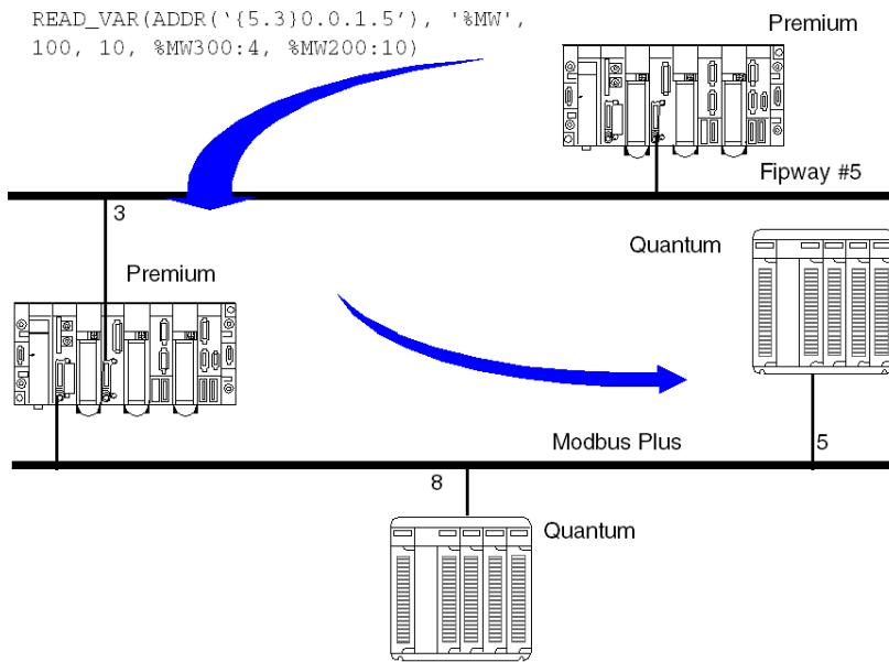
**NOTA:** l'instradamento tra Fipway e Modbus Plus è garantito dal sistema in automatico. In un'architettura, non è necessario dichiarare una stazione ponte.
