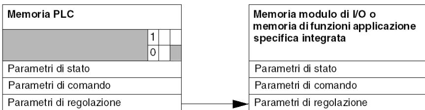
Quando l'istruzione è analizzata dal PLC, il bit **Scambio in corso** è impostato a 1 in %MW<sub>r.m.c.</sub>
