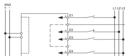
Lorsqu'un signal est établi sur une entrée avec une tension de bus existante, la LED d'état du canal jaune correspondant est allumée.
