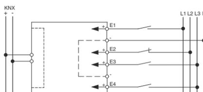
Wenn bei vorhandener Busspannung an einem Eingang ein Signal anliegt, leuchtet die entsprechende gelbe Kanal-Status-LED.
