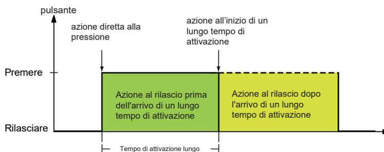
È necessario impostare l'azione appropriata per ogni fase di funzionamento. Oltre alla funzione fronti normale, è possibile impostare un tempo di ciclo per ogni oggetto. È possibile inviare una volta o ciclicamente. Ad esempio, è possibile utilizzare l'azione **Commuta ciclicamente, invia immediatamente, poi ciclicamente** per alternare ciclicamente le scene di illuminazione.
