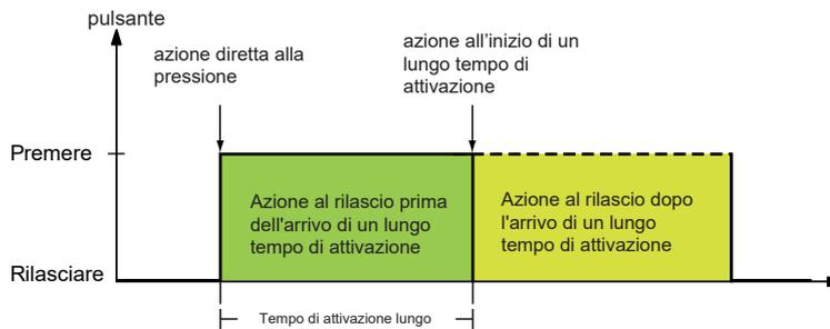
È necessario impostare l'azione appropriata per ogni fase di funzionamento. È possibile scegliere tra azioni eseguite una volta e azioni ripetute ciclicamente.
