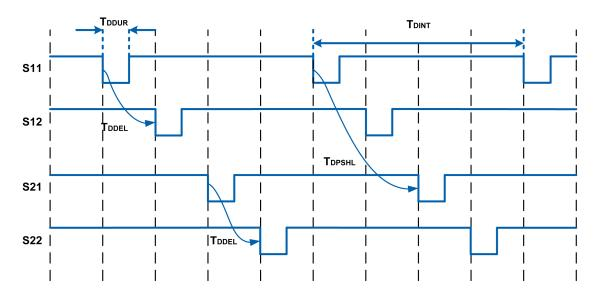
Il diagramma seguente illustra il principio di dinamizzazione e la temporizzazione dei canali Y1 e Y2 dell'ingresso di avvio/riavvio:
