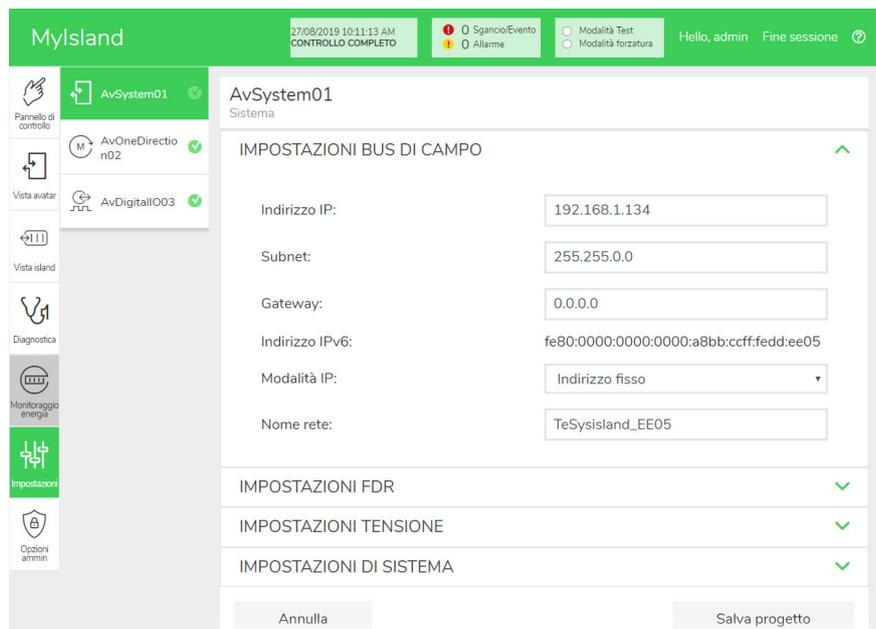
2. Acquisire il nome di rete del bus coupler esistente (necessario durante la configurazione del bus coupler sostitutivo).
