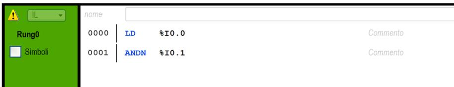
Se SoMachine Basic rileva uno o più errori di sintassi che impediscono la compilazione corretta del rung, compare un'icona di errore:
