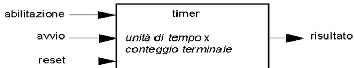
L'ingresso di attivazione attiva il timer nella posizione 0 e accumula *unità di tempo* (unità di 1, 10, 100 o 1000 ms) per un numero specificato di conteggi. L'ingresso di reset azzerà l'accumulatore del timer.
