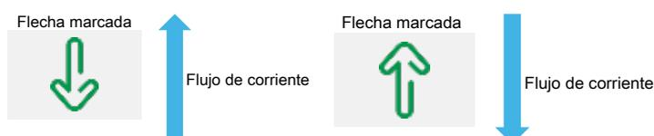
En las siguientes figuras se muestra la ubicación de la flecha marcada en los dispositivos PowerTag Energy F160 y Rope:
