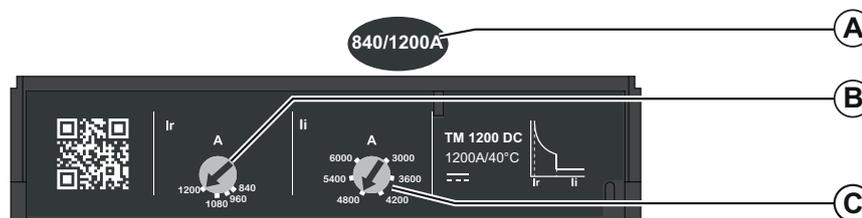
**A** TM-DC 热磁 2P 脱扣单元的设置范围
