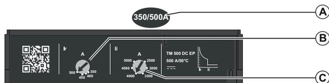
**A** TM-DC EP 热磁脱扣单元的设置范围
