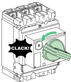
断路器因电气故障而脱扣，旋转手柄从 **I (ON)** 位置移动到 **Trip** 位置。
