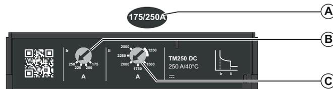
**A** TM-DC 热磁 3P/4P 脱扣单元的设置范围
