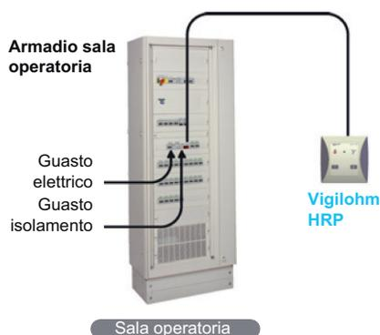
Il principio di connessione di HRP è illustrato nella figura seguente:
