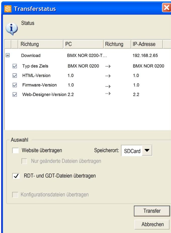
**HINWEIS:** Web Designer übernimmt weder die Übertragung noch das Rücksetzen von Protokollen. Für diese Vorgänge steht Ihnen die Weboberfläche des Moduls BMX NOR 0200 H zur Verfügung.
