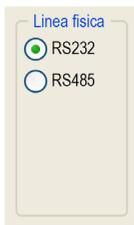
In questa zona è possibile scegliere due tipi di linea fisica per la porta seriale sul modulo BMXNOM0200
