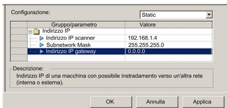
**NOTA:** La pagina visualizzata sopra è accessibile aprendo un modulo di comunicazione Ethernet nell'**editor dei dispositivi** e quindi selezionando **Proprietà canale** → **TCP/IP** nella struttura di navigazione.
