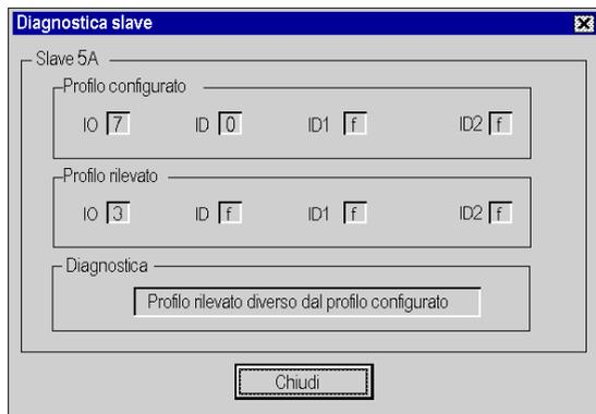
Questa finestra visualizza i seguenti errori rilevati per ogni dispositivo slave:
