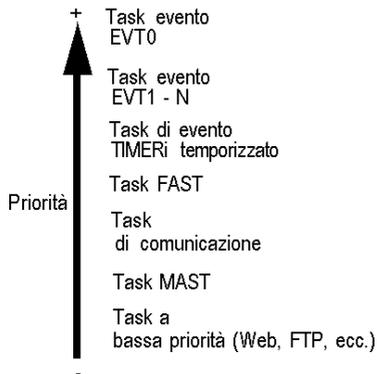
Lo schema seguente mostra l'esecuzione dei task in una struttura multitask:
