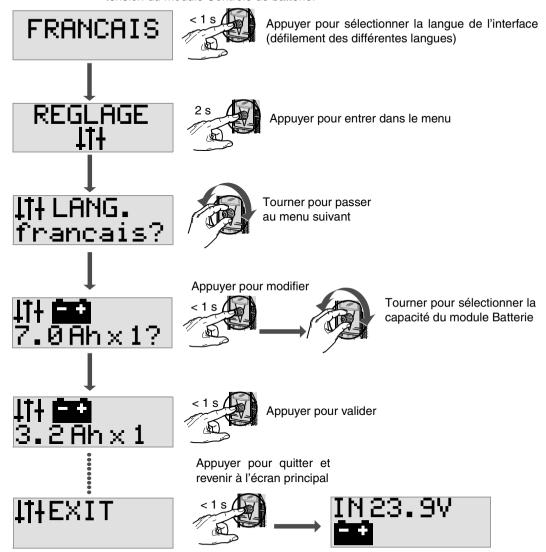
A la fin de ce premier paramètrage, le module de contrôle commence la charge du ou des modules Batterie. Le taux de charge n'étant pas mesurable, l'écran est orange jusqu'à la fin de charge. Après 72H maximum de mise sous tension de l'ensemble alimentation et module de contrôle, l'écran passe au vert et le pourcentage de charge du ou des modules Batterie est affiché (voir *Diagnostic*, p. 52).
