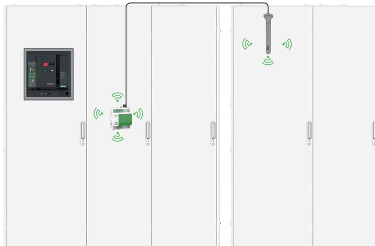
Abbildung 6: Panel-Server und Antenneninstallation in zwei Metallgehäusen
