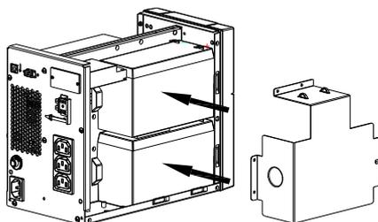
7. Effettuare i collegamenti in serie come quelli originali. Collegare nuovamente le batterie alla PCB. Riposizionare la piastra della batteria.
