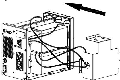
8. Fissare le viti (5) di fissaggio della piastra della batteria.
