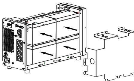
7. Effettuare i collegamenti in serie come quelli originali. Collegare nuovamente le batterie alla PCB. Riposizionare la piastra della batteria.
