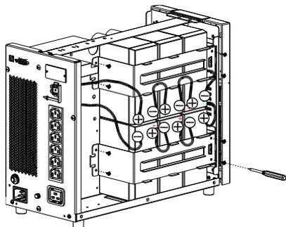
4. Scollegare i cavi della batteria e rimuovere la vecchia batteria.
