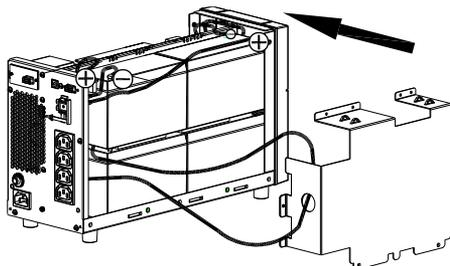
8. Fissare le viti (10) di fissaggio della piastra della batteria. Controllare il numero di viti.
