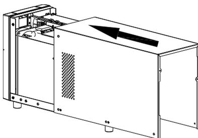
10. Fissare le viti (10) di fissaggio del coperchio superiore. Controllare il numero di viti.
