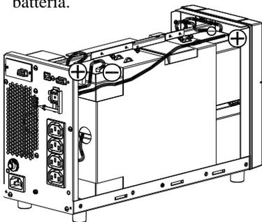
4. Individuare le viti (10) che fissano la piastra della batteria e svtarle. Controllare il numero di viti.
