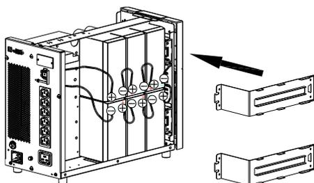
6. Fissare le viti (8) di fissaggio della piastra della batteria. Controllare il numero di viti.
