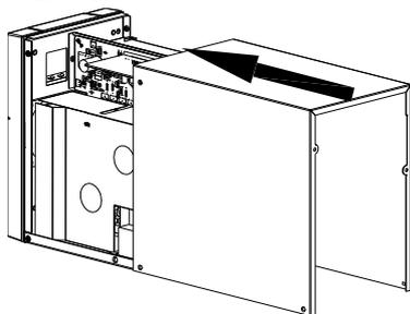
10. Fissare le viti (8) di fissaggio del coperchio superiore.
