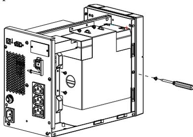
5. Rimuovere la piastra della batteria e le vecchie batterie.
