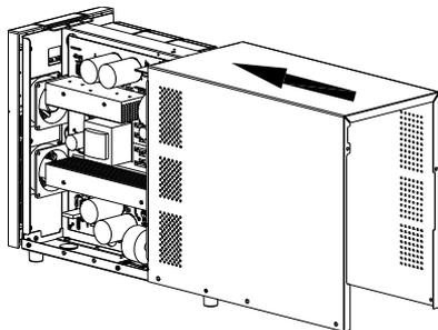
8. Fissare le viti (8) di fissaggio del coperchio superiore.
