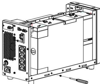
5. Rimuovere la piastra della batteria e le vecchie batterie.
