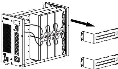
5. Inserire la nuova batteria. Effettuare i collegamenti in serie come quelli originali. Collegare nuovamente le batterie alla PCB. Riposizionare la piastra della batteria.
