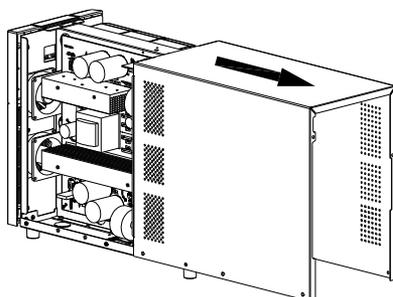
3. Individuare le viti (8) che fissano la piastra della batteria e svtarle. Controllare il numero di viti.
