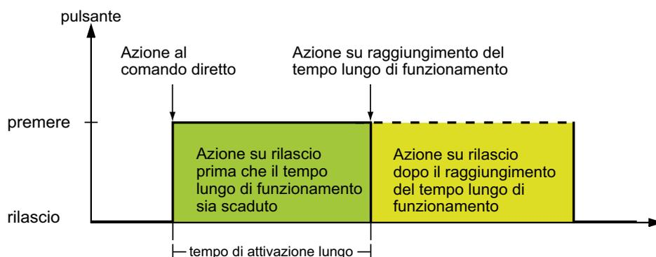
È necessario impostare l'azione appropriata per ogni fase di funzionamento. Oltre alla funzione fronti normale, è possibile impostare un tempo di ciclo per ogni oggetto. È possibile inviare una volta o ciclicamente.
