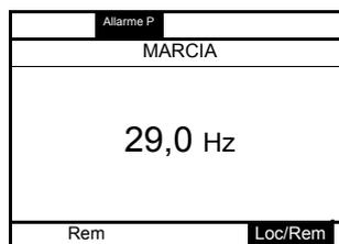
**Preallarme sovraccarico motore**
