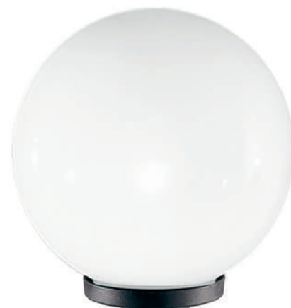
Diffusore in metacrilato con attacco a baionetta e griffa in materiale termoplastico con portalamпада con attacco E27.
