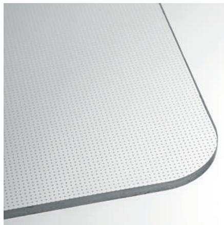
LGP (Light Guide Plate) è una particolare tecnologia luminosa basata su una lastra in resina di polimetilmetacrilato (PMMA) ad elevata purezza, sulla cui superficie viene micro-incisa una speciale matrice. La luce, convogliata lateralmente dalla fonte luminosa, si diffonde sulla lastra e viene distribuita uniformemente sulla superficie del pannello, ottenendo un illuminamento omogeneo, diffuso e privo di abbagliamento.
