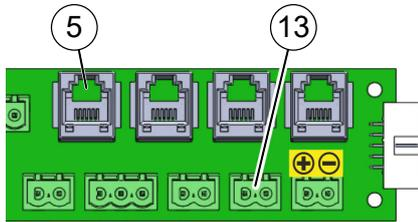
Fig. 9: Connections door contact switch
