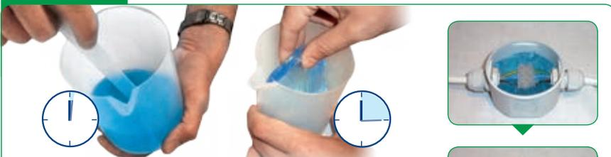
Colare i componenti nel misurino, miscelare e lasciare reticolare (circa 15 minuti). Togliere l'isolante, e posizionarlo in piccole parti attorno alla connessione in modo che ne sia completamente ricoperta. Naturalmente può utilizzarsi l'isolante conservato da precedenti miscele.
