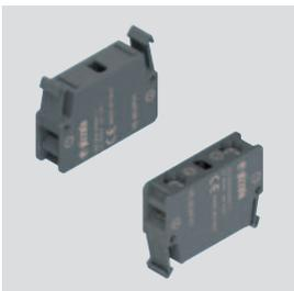
Blocchi di connessione dimensionalmente uguali alle unità di contatto ma privi di contatti elettrici. Dotati di due morsetti elettricamente separati permettono l'installazione del disco luminoso serie VE DL senza ulteriori morsetti o crimpature.
