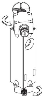
Il modulo superiore dell'interruttore, che incorpora i dispositivi di sblocco, ed il modulo inferiore, che comprende le uscite di connessione, sono orientabili e non distaccabili: agendo sulle viti di fissaggio è possibile ruotare di 90° i moduli, ottenendo così con lo stesso articolo ulteriori configurazioni differenti senza che l'installatore si debba preoccupare su come assemblare i vari pezzi.
