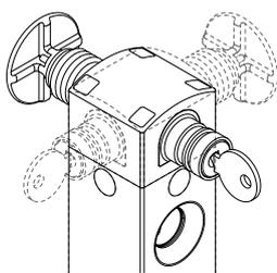
Il dispositivo di sblocco a serratura (auxiliary release) permette lo sblocco dell'azionatore solo al personale in possesso della chiave di azionamento. Funziona anche in assenza di alimentazione ed una volta azionato impedisce il blocco della protezione.
