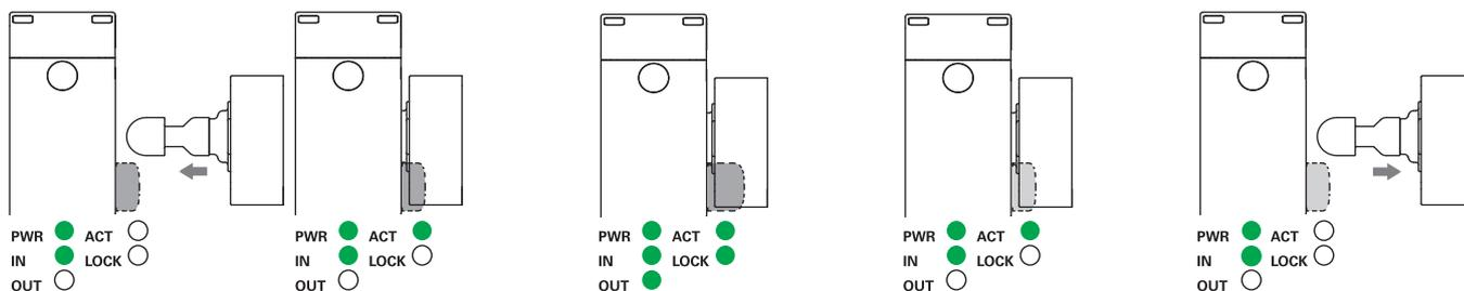
L'interruttore è alimentato (LED PWR acceso verde), gli ingressi IS1, IS2 sono abilitati (LED IN acceso verde), le uscite di sicurezza OS1, OS2 sono disabilitate (LED OUT spento). L'azionatore è all'esterno della zona di azionamento (LED ACT spento).
