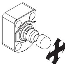
Tutti gli azionatori della Serie NS sono di tipo snodato e permettono al perno di adattarsi al foro di centraggio presente nell'interruttore. In questo modo non sono necessarie precise operazioni di allineamento azionatore-interruttore durante la fase di installazione. Inoltre grazie alla sua flessibilità può essere utilizzato su ripari con raggio minimo d'azionamento di 150 mm, senza dover preventivamente inclinare il perno.
