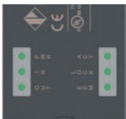
Progettati per una diagnostica rapida ed immediata, lo stato di ogni ingresso ed uscita viene evidenziato con un apposito LED. In questo modo si possono individuare rapidamente i punti di interruzione della catena sicura, quale dispositivo sia sbloccato, quale riparo sia aperto ed eventuali errori interni al dispositivo. Il tutto in modo immediato senza la necessità di decodificare complesse sequenze di lampeggi.
