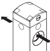
L'interruttore è dotato di un foro passante per l'inserimento dell'azionatore e grazie a questa particolarità l'eventuale sporcizia che dovesse entrare nel foro dell'azionatore ha sempre la possibilità di uscire dalla parte opposta, anziché fermarsi al suo interno. Inoltre il perno di blocco è dotato di una guarnizione a membrana esterna che lo rende adatto all'utilizzo in ambienti con presenza di polvere.
