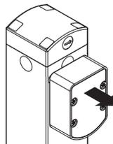
**2100 N** Il robusto sistema di interblocco garantisce una forza di ritenuta massima dell'azionatore  $F_{TEST}$  pari a 2100 N.
