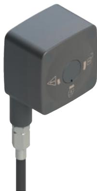
Lo sblocco di fuga remoto (remote escape release) è azionato tramite un cavo flessibile e consente di sbloccare l'interruttore di sicurezza a distanza, nei casi in cui i dispositivi di sblocco tradizionali (a serratura, a cacciavite, a pulsante, ecc.) non risultassero facilmente accessibili a causa della configurazione del macchinario.
