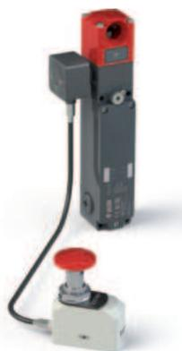
Gli interruttori di sicurezza NG ed NS con sblocco di fuga remoto vengono forniti con il relativo dispositivo collegato alla testa dell'interruttore e con un robusto cavo in acciaio, di lunghezza 5 metri, che scorre all'interno di una guaina con anima in acciaio.
