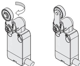
Negli interruttori a leva girevole è possibile fissare la leva dritta o rovescia mantenendo l'accoppiamento positivo.
