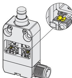
Gli articoli con unità di contatto C11, C02, C12, C22 sono caratterizzati da contatti elettrici con forma a "V". Questa configurazione riduce la probabilità di errore durante l'azionamento e garantisce una commutazione dei contatti ancora più affidabile, grazie ai punti di appoggio raddoppiati rispetto ai contatti di forma piana e all'azione autopulente del contatto. Disponibili nelle versioni a scatto rapido, questi articoli sono particolarmente indicati per l'utilizzo nel settore ferroviario.
