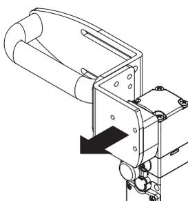
**9750 N** Il robusto sistema di interblocco garantisce una forza di ritenuta massima dell'azionatore  $F_{1max}$  pari a 9750 N. Questo valore è uno dei più elevati presenti oggi sul mercato e rende il dispositivo adatto per applicazioni molto gravose.
