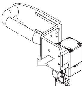
Ogni interruttore è dotato al proprio interno di un dispositivo di trattenuta dell'azionatore nella posizione di chiusura. Ideale per tutte quelle applicazioni dove più porte vengono contemporaneamente sbloccate, ma solo una viene effettivamente aperta. Il dispositivo mantiene in posizione tutte le porte sbloccate con una forza di 30 N, evitando che vibrazioni o colpi di vento possano aprirle.
