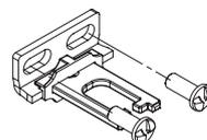
Come prescritto dalla norma EN ISO 14119 l'azionatore deve essere fissato al telaio del riparo in modo inamovibile. A questo scopo sono disponibili viti di sicurezza a testa bombata, con impronta one-way. Con questo tipo di viti gli azionatori non possono essere tolti o manomessi mediante attrezzature di uso comune. Vedi accessori a pagina 349.
