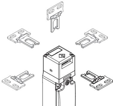
Togliendo le due viti di fissaggio, in tutti gli interruttori, è possibile ruotare la testa di 90° in 90°. In questo modo è possibile azionare l'interruttore da 5 diverse direzioni.
