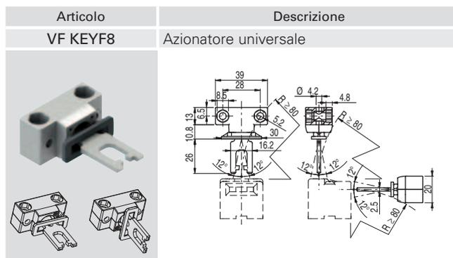
Azionatore snodato per ripari disallineati, fissabile in molteplici posizioni con possibilità di regolazione in due direzioni per sportelli di piccole dimensioni.
