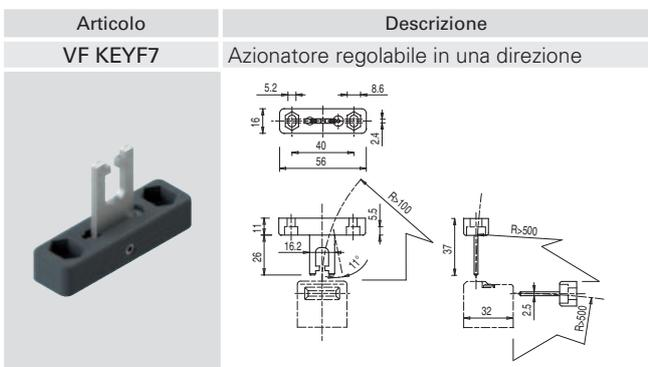
Azionatore con possibilità di regolazione in una direzione per ripari di piccole dimensioni.
