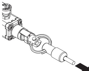
Questi interruttori possono essere forniti a richiesta con molle interne di durezza ridotta. E' così possibile ridurre lo sforzo fisico necessario per azionare l'interruttore mantenendo invariata la corsa di azionamento dei contatti elettrici. Particolarmente indicate per campate di dimensioni ridotte, vanno sempre abbinate a sospensioni della fune a carrucola.
