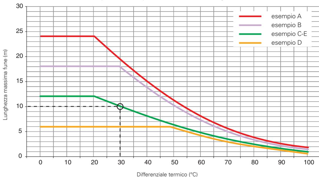
Nel diagramma sono indicate le campate massime consigliate in funzione degli sbalzi di temperatura (differenziale termico) a cui si prevede che l'interruttore sarà sottoposto nell'ambiente di lavoro. Ad esempio in un'installazione di tipo C, per la quale si prevede un differenziale termico di 30°C, è consigliata una lunghezza massima della fune di 10 m.
