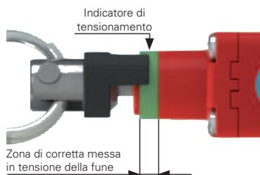
Tutti gli interruttori sono dotati di un anello verde che mostra la zona di corretta messa in tensione della fune. L'installatore non deve far altro che tendere la fune fino a che l'indicatore nero di tensionamento giunge nel mezzo della zona verde. A questo punto è possibile resettare l'interruttore tirando l'apposito
