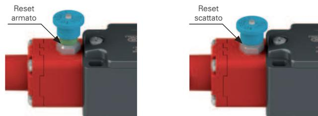
Se l'indicatore di tensionamento della fune si trova nella zona di corretta messa in tensione è possibile chiudere i contatti elettrici di sicurezza tirando il pomello blu. L'anello verde di segnalazione permette di capire rapidamente lo stato del reset.
