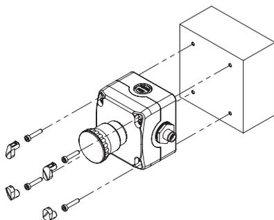
Le viti di fissaggio a parete e di chiusura del coperchio della scatola possono essere sigillate tramite 4 tappi (forniti con la scatola) che, oltre a rendere esteticamente più gradevole la scatola, hanno la funzione di evitare l'accumulo di sporco all'interno degli incavi per le viti e di rendere più difficoltosa la manomissione delle stesse.
