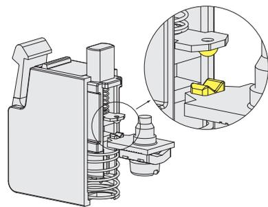
Contatti autopulenti con forma a "V" a quadruplo punto di appoggio. Questo tipo di sagoma, grazie alla presenza del quadruplo punto di appoggio, consente di ridurre drasticamente le probabilità di errore di commutazione del contatto. Inoltre migliora sensibilmente l'affidabilità in caso di presenza di polvere.
