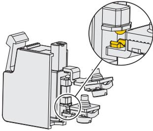
Contatti autopulenti con forma a "V" a quadruplo punto di appoggio. Questo tipo di sagoma, grazie alla presenza del quadruplo punto di appoggio, consente di ridurre drasticamente le probabilità di errore di commutazione del contatto. Inoltre migliora sensibilmente l'affidabilità in caso di presenza di polvere.
