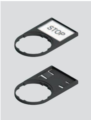
Portatarghette per dispositivo singolo, orientabili di 90° in 90°. Possono essere utilizzate targhette di altri costruttori (per esempio: 3M articolo KE-7270-2691-3 oppure GRAFOPLAST articolo SITM612X) purché rispettino le seguenti dimensioni: base 27 +0/-0,4 mm, altezza 18+0/-0,4 mm, spessore 0,8 ±0,4 mm.
