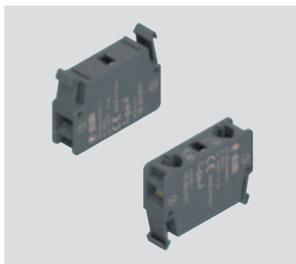
Blocchi con diodo dimensionalmente uguali alle unità di contatto, contenenti all'interno un diodo 3 A 1800 V. Da utilizzare nei rami di circuiti in cui è necessario garantire che il verso di percorrenza della corrente rispetti la polarità prevista.
