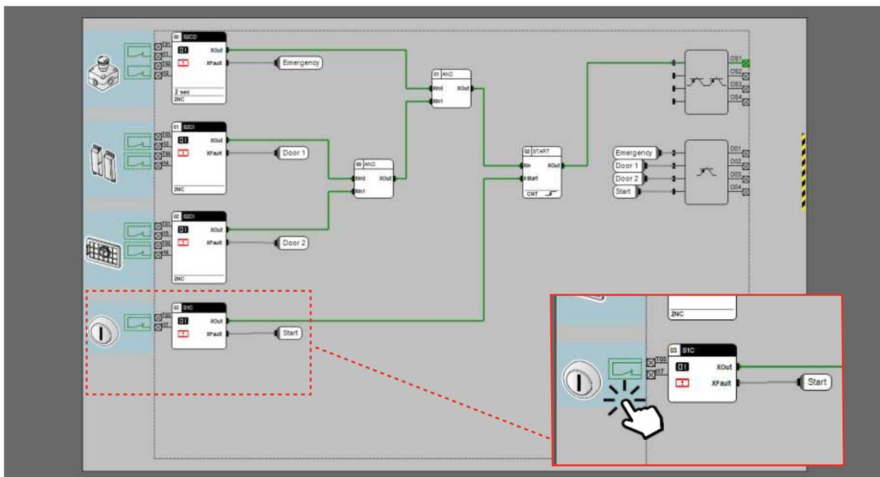
Gemis Studio è dotato di un ambiente di simulazione utile per effettuare prove sul Programma Applicativo che si sta realizzando e verificarne il corretto funzionamento prima di installarlo su un modulo. Per avviare la simulazione del Programma Applicativo in fase di sviluppo è sufficiente premere il tasto Start sulla barra dei pulsanti presente nella parte superiore del desktop. Se il Programma Applicativo non è compilabile, la simulazione non viene avviata.
