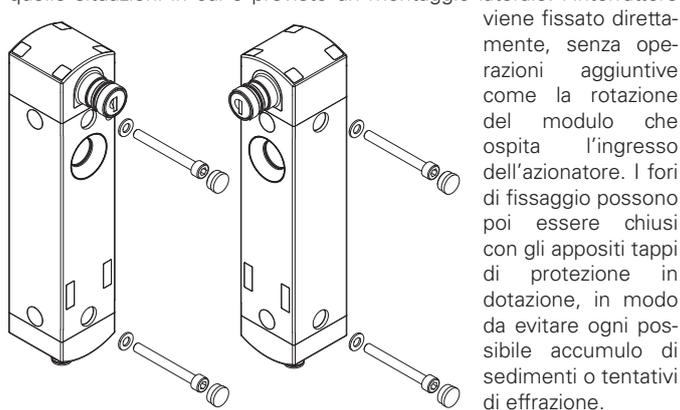
viene fissato direttamente, senza operazioni aggiuntive come la rotazione del modulo che ospita l'ingresso dell'azionatore. I fori di fissaggio possono poi essere chiusi con gli appositi tappi di protezione in dotazione, in modo da evitare ogni possibile accumulo di sedimenti o tentativi di effrazione.
