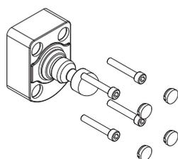
Ogni azionatore della serie NS viene fornito completo di quattro tappi di protezione ad incastro. Questi tappi, oltre a prevenire l'accumulo di sedimenti e facilitare la pulizia, precludono l'accesso alle viti di fissaggio dell'azionatore. Pertanto si possono utilizzare viti standard al posto delle viti anti-effrazione.
