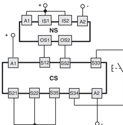
Collegamenti con i moduli di sicurezza CS AR-05... / CS AR-06...
