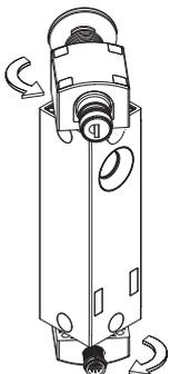
Il modulo superiore dell'interruttore, che incorpora i dispositivi di sblocco, ed il modulo inferiore, che comprende le uscite di connessione, sono orientabili e non distaccabili: agendo sulle viti di fissaggio è possibile ruotare di 90° in 90° i moduli, ottenendo così con lo stesso articolo ulteriori configurazioni differenti senza che l'installatore si debba preoccupare su come assemblare i vari pezzi.
