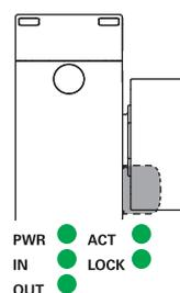
Attraverso gli ingressi IE1 e IE2 si può bloccare l'azionatore (LED LOCK acceso verde). Le uscite di sicurezza OS1, OS2 vengono abilitate (LED OUT acceso verde). Contemporaneamente viene attivata l'uscita di segnalazione O4. La zona sicura di azionamento si espande in modo da consentire un maggior gioco da parte dell'azionatore.
