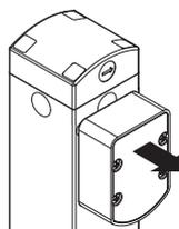
**2100 N** Il robusto sistema di interblocco garantisce una forza di ritenuta massima dell'azionatore  $F_{1max}$  pari a 2100 N.
