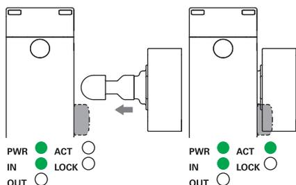
L'interruttore è alimentato (LED PWR acceso verde), gli ingressi IS1, IS2 sono abilitati (LED IN acceso verde), le uscite di sicurezza OS1, OS2 sono disabilitate (LED OUT spento). L'azionatore è all'esterno della zona di azionamento (LED ACT spento).
