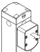
Ogni interruttore è dotato al proprio interno di un dispositivo di trattenuta dell'azionatore nella posizione di chiusura. Ideale per tutte quelle applicazioni dove più ripari vengono contemporaneamente sbloccati, ma solo uno viene effettivamente aperto. Il dispositivo mantiene in posizione tutti i ripari sbloccati con una forza di circa 20 N, evitando che vibrazioni o colpi di vento possano aprirli.
