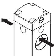
L'interruttore è dotato di un foro passante per l'inserimento dell'azionatore e grazie a questa particolarità l'eventuale sporcizia che dovesse entrare nel foro dell'azionatore ha sempre la possibilità di uscire dalla parte opposta, anziché fermarsi al suo interno. Inoltre il perno di blocco è dotato di una guarnizione a membrana esterna che lo rende adatto all'utilizzo in ambienti con presenza di polvere.
