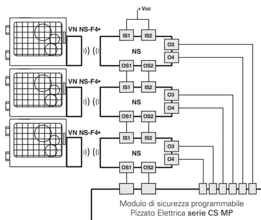
Possibilità di collegamento in serie di più interruttori per semplificare il cablaggio del sistema di sicurezza, previa valutazione delle uscite dell'ultimo interruttore della catena da parte di un modulo di sicurezza Pizzato Elettrica della serie CS MP, che permette la gestione sia della parte di sicurezza sia della parte di segnalazione.
