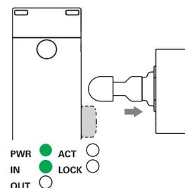
All'uscita dell'azionatore dalla zona limite di azionamento, il dispositivo spegne il LED ACT e disattiva l'uscita di segnalazione O3.
