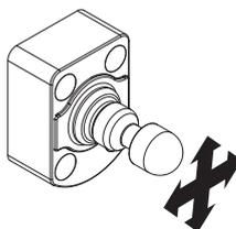
Tutti gli azionatori della Serie NS sono di tipo snodato e permettono al perno di adattarsi al foro di centraggio presente nell'interruttore. In questo modo non sono necessarie precise operazioni di allineamento azionatore-interruttore durante la fase di installazione. Inoltre grazie alla sua flessibilità può essere utilizzato su ripari con raggio minimo d'azionamento di 150 mm, senza dover preventivamente inclinare il perno.
