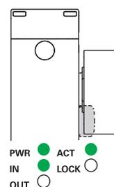
Attraverso gli ingressi IE1 e IE2 si può sbloccare l'azionatore (LED LOCK spento). L'interruttore disabilita le uscite di sicurezza OS1, OS2 e spegne il LED OUT. Contemporaneamente viene disattivata l'uscita di segnalazione O4. La zona di azionamento sicuro torna ai valori iniziali.
