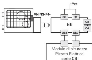
L'interruttore serie NS può essere usato singolarmente, previa valutazione delle uscite sicure da parte di un modulo di sicurezza Pizzato Elettrica (vedi tabella moduli di sicurezza abbinabili).
