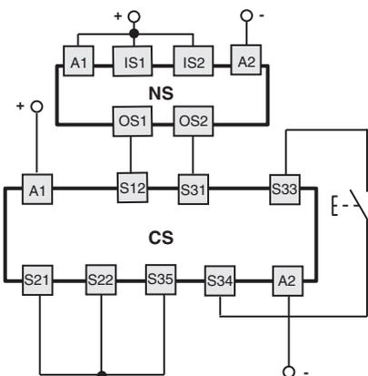
Collegamenti con i moduli di sicurezza CS MF..., CS MP...
