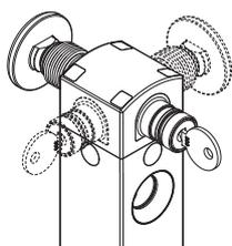
Il dispositivo di sblocco a serratura (auxiliary release) permette lo sblocco dell'azionatore solo al personale in possesso della chiave di azionamento. Funziona anche in assenza di alimentazione ed una volta azionato impedisce il blocco della protezione.
