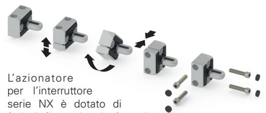
L'azionatore per l'interruttore serie NX è dotato di fori di fissaggio sia frontali che laterali per le viti M5. Inoltre, è possibile aprire i due semigusci che compongono il corpo dell'azionatore e ruotare il perno, in modo da ruotare di 90° il piano di lavoro dell'azionatore.
