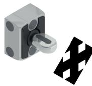
L'azionatore per l'interruttore serie NX è di tipo snodato e permette al perno di adattarsi al foro di centraggio presente nell'interruttore. In questo modo non sono necessarie precise operazioni di allineamento azionatore-interruttore durante la fase di installazione.
