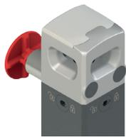
Il dispositivo di sblocco a chiave esagonale (auxiliary release) permette lo sblocco dell'azionatore solo con chiave esagonale. Funziona anche in assenza di alimentazione ed una volta azionato impedisce il blocco della protezione. L'interruttore è disponibile in versione con uno sblocco ausiliario frontale o con tre sblocchi ausiliari disposti sui 3 lati dell'interruttore.
