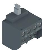
Innovativa unità di contatto a 4 contatti disponibile in diverse configurazioni di contatti per monitorare l'azionatore o l'elettromagnete (brevettata). L'unità è dotata di viti imperdibili e piastrine autosollevanti. Protezioni anti-dito rimovibili per capicorda ad occhiello.
