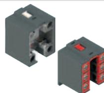
Unità di contatto con viti imperdibili, protezione antidito e contatti a doppio ponte e doppia interruzione per una maggiore affidabilità di contatto. Disponibili in molteplici varianti con corse di azionamento scalate, simultanee o sovrapposte. Si adattano alle più svariate applicazioni.
