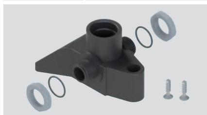
Kit unione per pedali in tecnopolimero con foro filettato M25x1,5 per VF KIT31 o VF KIT29 completo di dadi, guarnizioni e viti autofilettanti per il fissaggio di due pedali singoli. Grado di protezione IP65.
