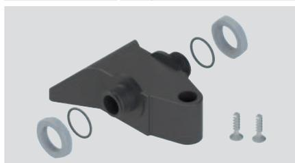
Dispositivo di unione per pedali in tecnopolimero con foro per asta di trasporto, completo di dadi, guarnizioni e viti autofilettanti per il fissaggio di due pedali singoli. Grado di protezione IP65.
